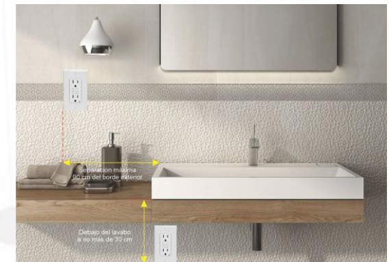
210-52 (d) Contactos instalados en baños
