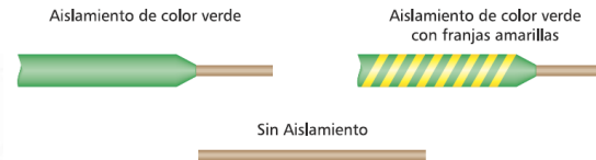
Fig. 58 Código de colores de los conductores de puesta a tierra
